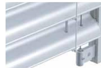
Die windstabile Ausführung ermöglicht die Nutzung bis zu 80 km/h. Dabei werden die Lamellen zusätzlich zu den Führungsschienen von mind. 2 polyamidummantelten Edelstahlseilen geführt. Die Abspannkonsolen für die 2 äußeren Windsicherungen werden direkt auf die Führungsschiene montiert.
