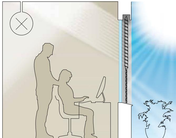
Mit der HELLA-Lichtlenkfunktion besteht nicht nur Sicht- und Blendschutz, sondern das Tageslicht wird optimal genutzt um den Raum zu erhellen. Kein künstliches Licht = Wohlfühlatmosphäre und Energie sparen in Einem!
